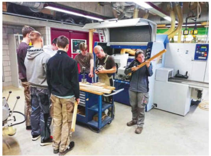
*/ Durch den Einsatz verschiedener Messerköpfe kann an der Kehlmaschine die unterschiedliche Oberflächengüte beim Hobeln sofort geprüft werden.*
